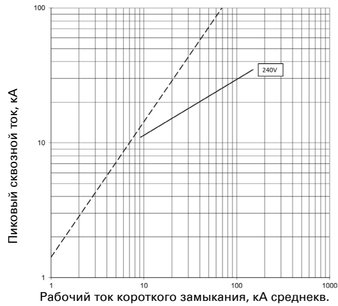
Сквозной ток I_D PDE2 ETU PXR10 LI; 160 А при 240 В
